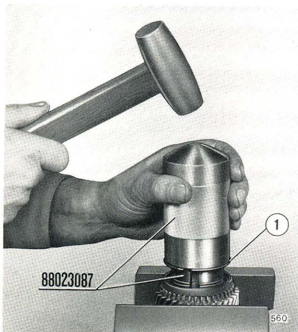
Fig. 81 - Montaggio anello elastico sincronizzatore
