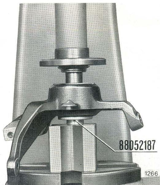
Fig. 100 - Montaggio mozzo sotto pressa
