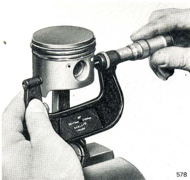
Fig. 46 - Misurazione stantuffi
