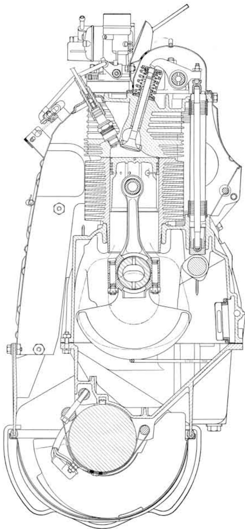
Fig. 5. - Mod. 500 Giardiniera - Sezione trasversale del motore su un cilindro.
