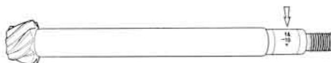
Fig. 17. - Albero secondario con pignone conico.
