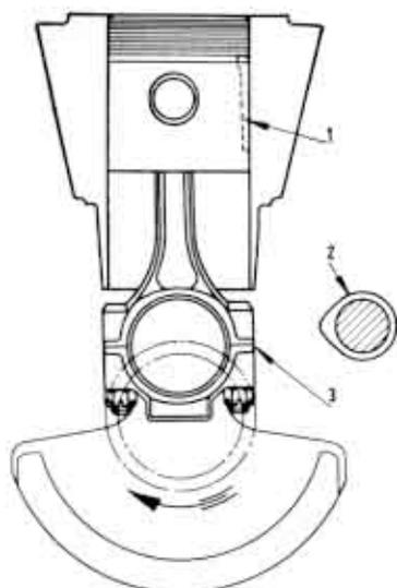
Fig. 6. - Modd. 500 L - 500 - 500 D e Nuova 500 Sport - Schema per il montaggio del complessivo biella-stantuffo sul motori.
