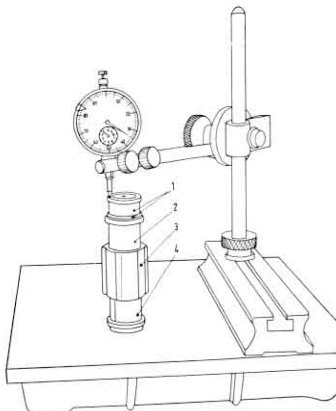
Fig. 19. - Lettura del valore « c » sul comparatore.
