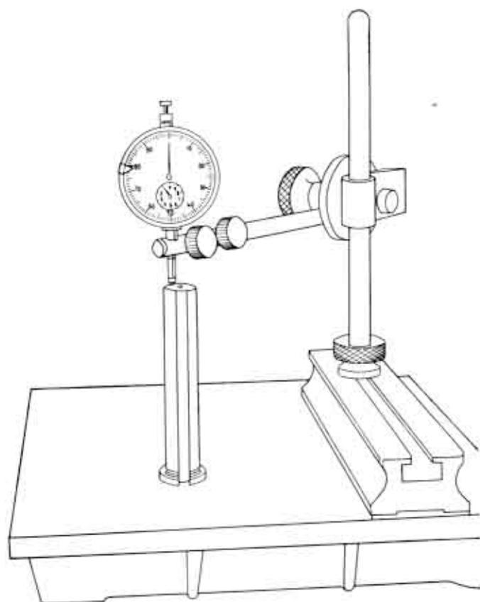
Fig. 18. - Azzeramento del comparatore sull'attrezzo A. 70037.
