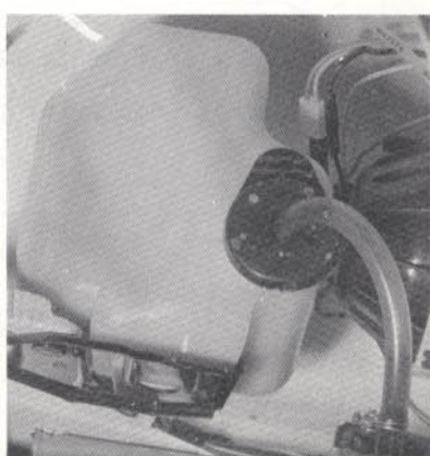
Vaschetta di espansione: ad innesto rapido tramite incastro
