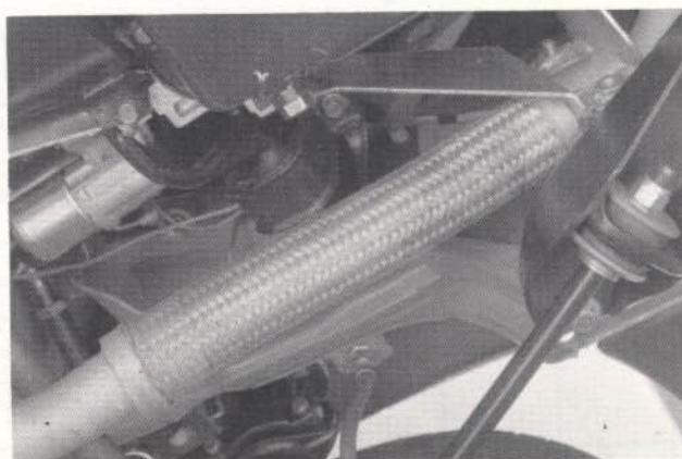
Parte flessibile del tubo di scarico
