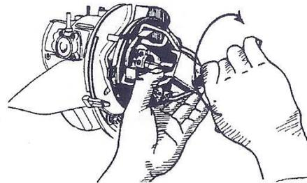
Positionnez le stator muni de son roulement sur le vilebrequin et engagez les 3 vis de fixation (les 2 intérieures munies de rondelles éventail prisonnières).
