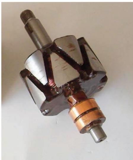
**Il rotore dell'alternatore del 127, 128 e A112**
