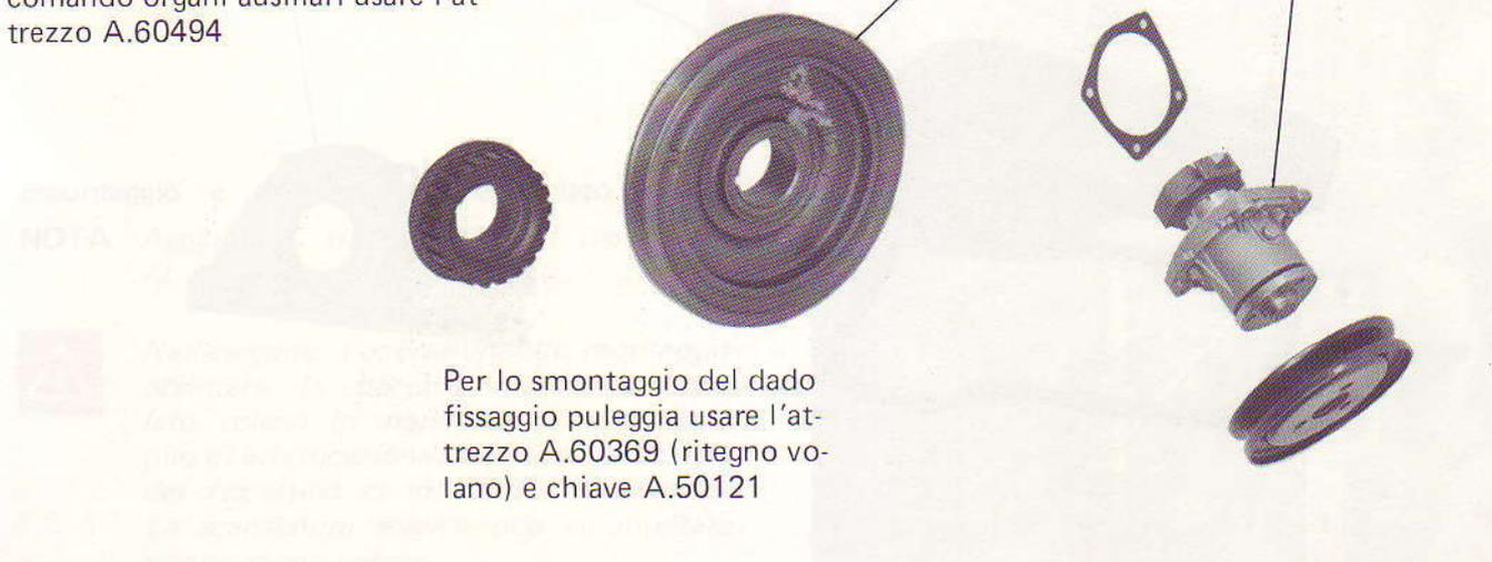
Per lo smontaggio del dado fissaggio puleggia usare l'attrezzo A.60369 (ritegno volante) e chiave A.50121
