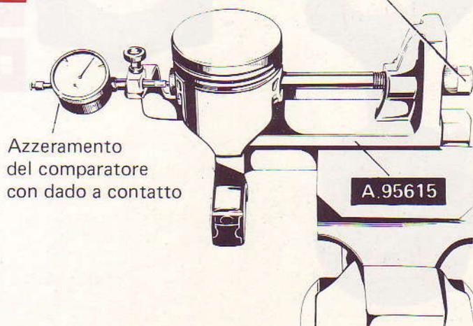
**Posizionamento del gruppo biella-perno stantuffo montato sull'attrezzo per la prova di tenuta del perno allo sfilamento.**
