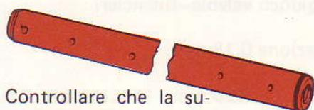
Controllare che la superficie esterna non presenti tracce di ingranamento e che i fori di lubrificazione non siano ostruiti.
