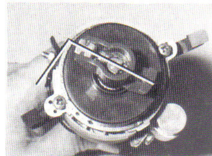
Posizionamento spazzola prima del riattacco distributore su motore G13A
