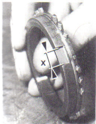
X = punto misurazione tacca chiave su anello sincronizzatore
