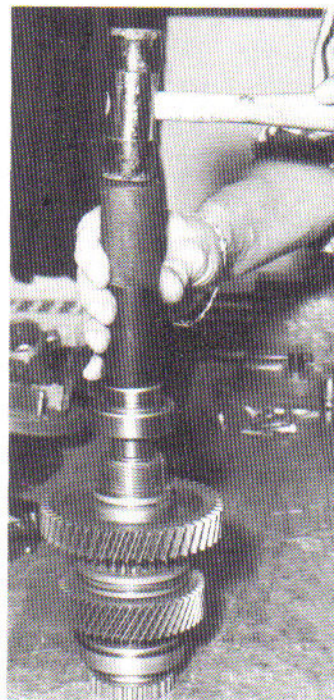
Riattacco cuscinetto e bussola di spallamento su albero uscita
