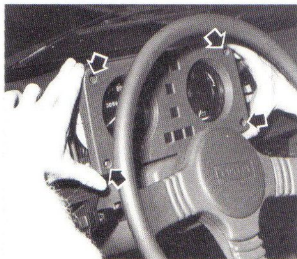
Stacco pannello portastrumenti su 410 - Freccie: posizionamento viti montaggio
