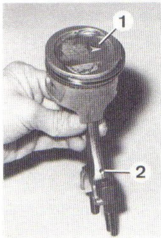
Senso montaggio biella su stantuffo 1. Freccia su cielo stantuffo - 2. Passaggio olio
