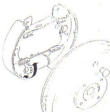
Regolazione freno attraverso tamburo interno ad arresto ganaschia
