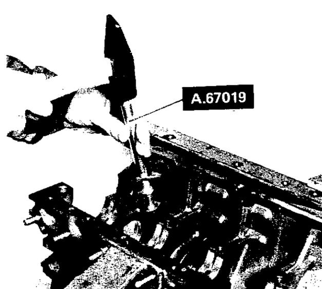
Smontaggio boccola per ingranaggio comando pompa olio
