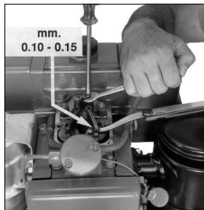
Per registrare il gioco tra valvole e bilancieri: Togliere il cappello bilancieri - Girare l'albero motore fino a portare il pistone al punto morto superiore, in fase di compressione. Allentare i dadi bloccaggio viti di registro - Inserire lo spessimetro (mm 0,10 aspirazione e mm 0,15 scarico) tra i bilancieri e la valvola. Avvitare le viti di registro, fino che lo spessimetro si possa sfilare senza incontrare resistenza. Serrare i dadi bloccaggio viti di registro.
