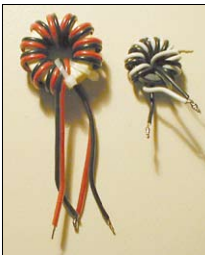
Foto 4 - I due balun di prova appena avvolti.
