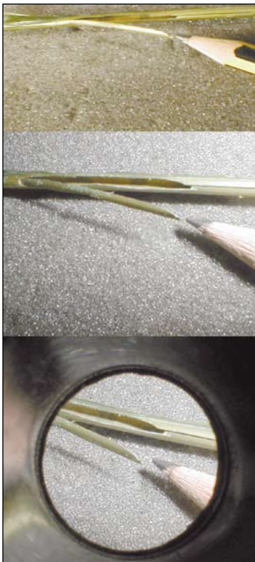
Foto 1 - Una delle rotture a diversi ingrandimenti
