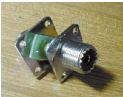
Assemblaggio dei due PL invertitori.
