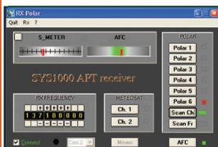
Ricevitore a sintesi da 130 a 139 MHz
