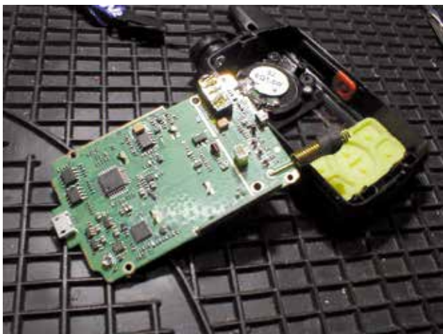
Foto 2 - La radio aperta, in alto il suo antennino integrato
