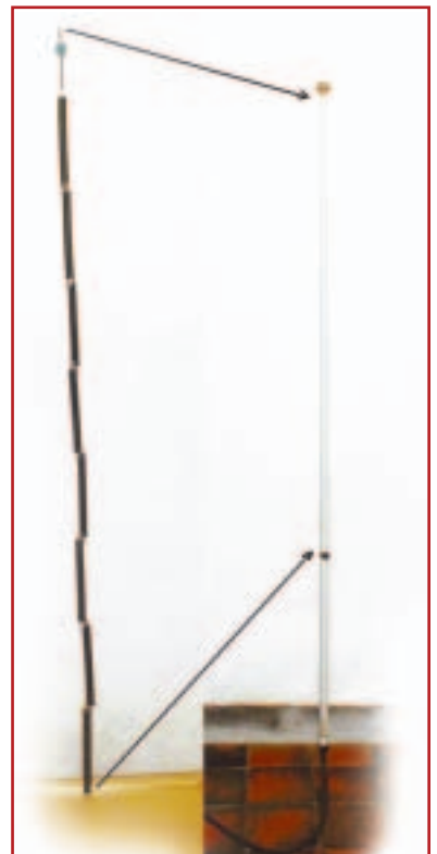
foto 4 (a fianco): antenna saldata ed inserita nel supporto
