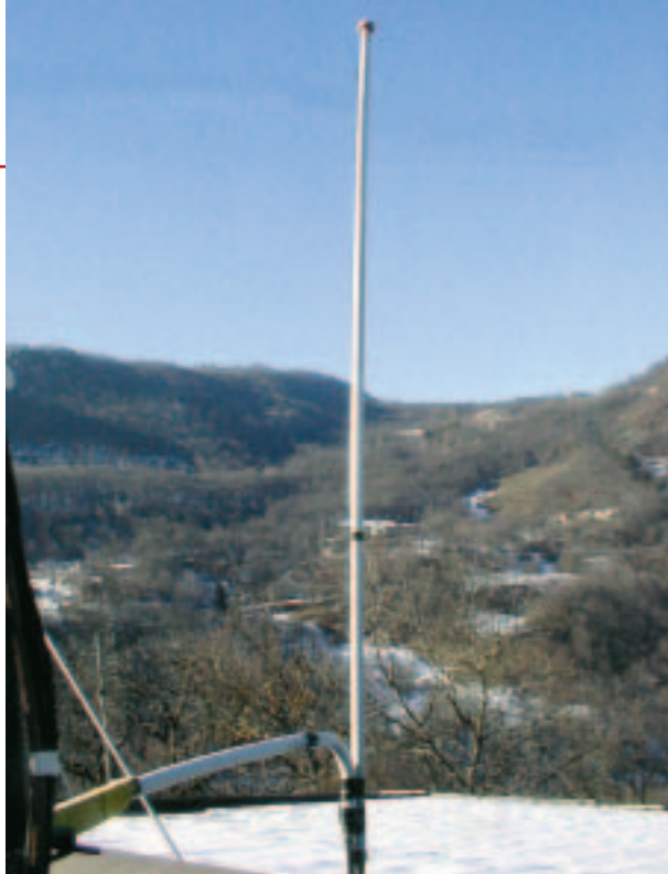
foto 2: l'antenna montata in prova sul tetto
