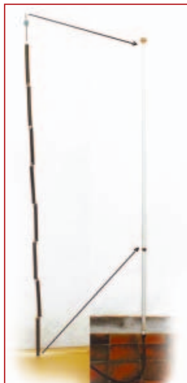
foto 4 (a fianco): antenna saldata ed inserita nel supporto
