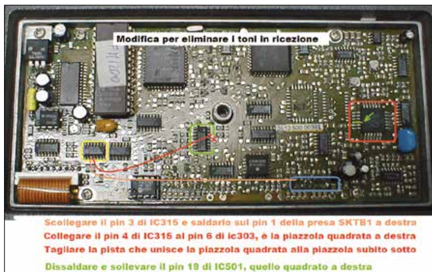
Modifica per eliminare i toni in ricezione
