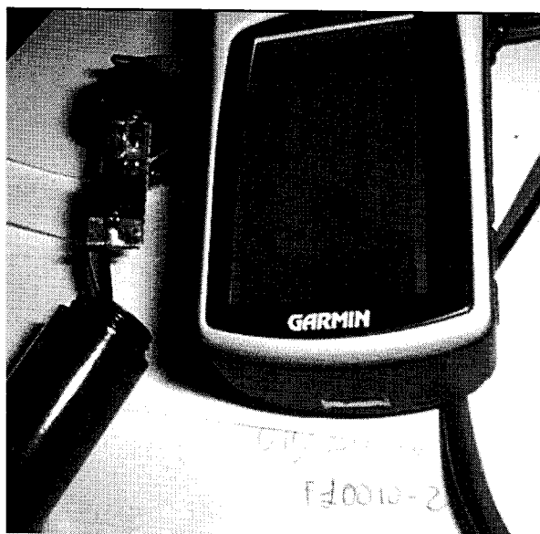
Foto 5 - Stabilizzatore assemblato nel connettore accendino, è visibile il cambio di simbolo in basso a sinistra sul display.
