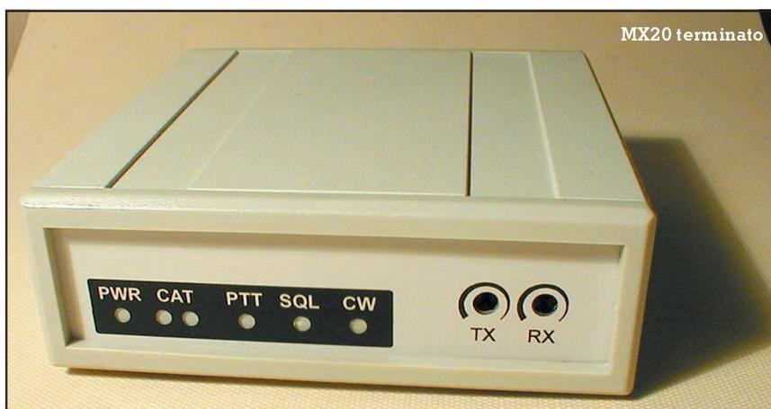
**S**i tratta di una interfaccia tra radio e PC il cui compito è di isolare completamente i due componenti.
