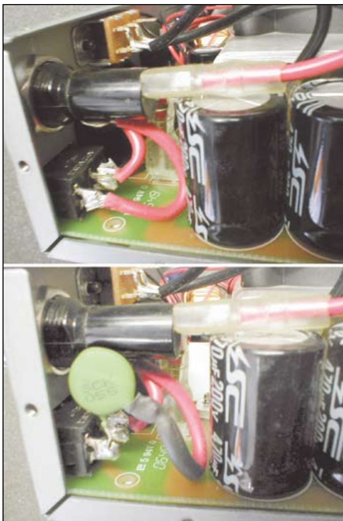
Foto 4 - Montaggio dell'NTC nell'alimentatore
