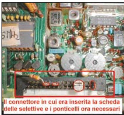
Il connettore in cui era inserita la scheda delle selettive e i ponticelli ora necessari
