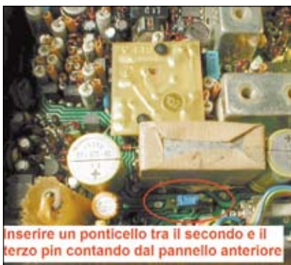
Ponticello sulla presa laterale a 5 pin.
