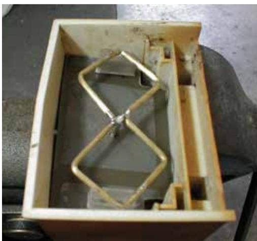
Antenna assemblata nel contenitore
