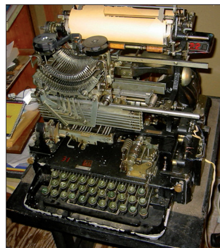
Figura 1: macchina telescrivente meccanica, il modello 15.
