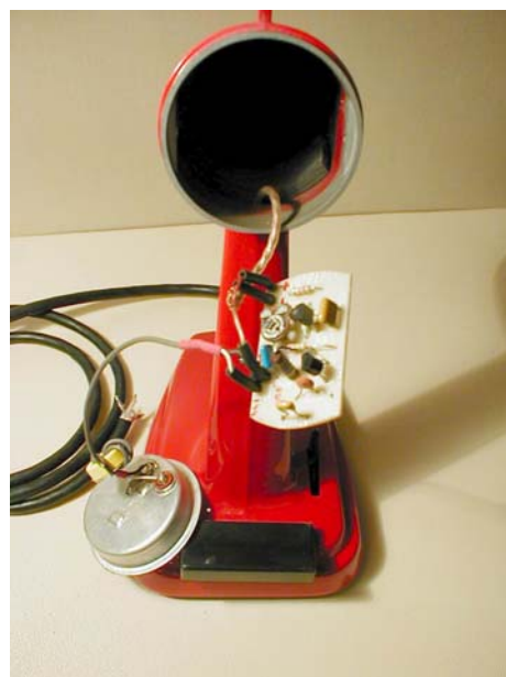
Figura 2 – Il preamplificatore montato nella testa del microfono
