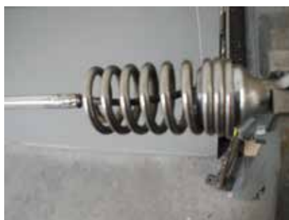
Foto 5 - Il filo passa all'interno della molla ed è saldato da entrambe le parti
