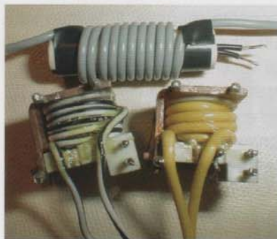
Foto 2 - Relè modificati e reed
