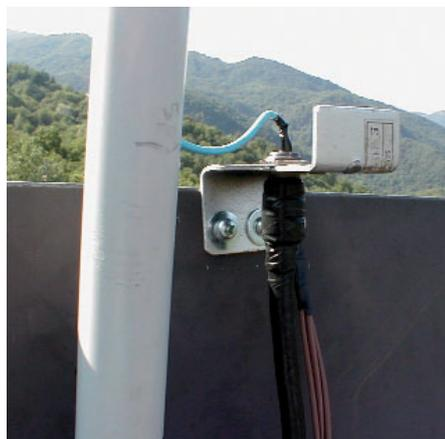
Il quarto d'onda in 20 metri (5,19 m) supportato da una canna da pesca (fibra di vetro) e un tubo in PVC
