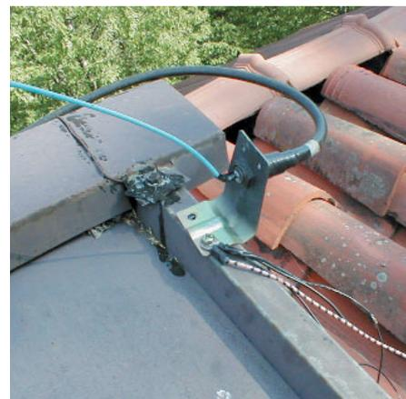
Il quarto d'onda in 80 metri (19,5 m) teso tra due supporti, come un solo braccio di un dipolo
