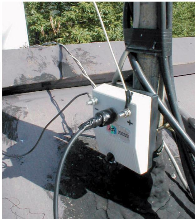
Figura 5 Il balun collegato a una long wire di 44 metri
