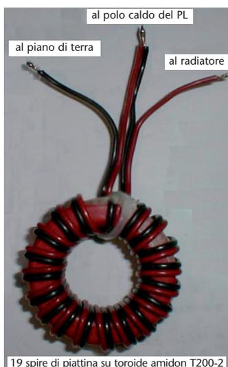
Figura 4 L'avvolgimento realizzato su un toroide
