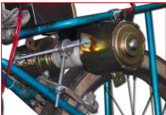
foto 2 I due motori, il rullo in hostaform e il tirante in filettato da 6 MA
