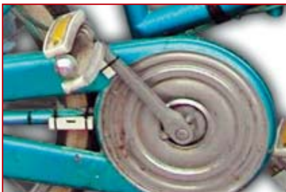
foto 7 Reed montato sul pedale
