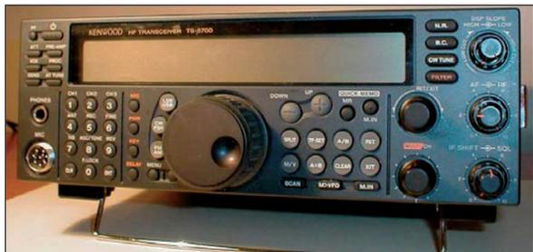
Figura 15: Kenwood TS570, è un RTX HF con accordatore interno e DSP. Della metà degli anni Novanta, oggi potrebbe valere 500 - 600 euro.
