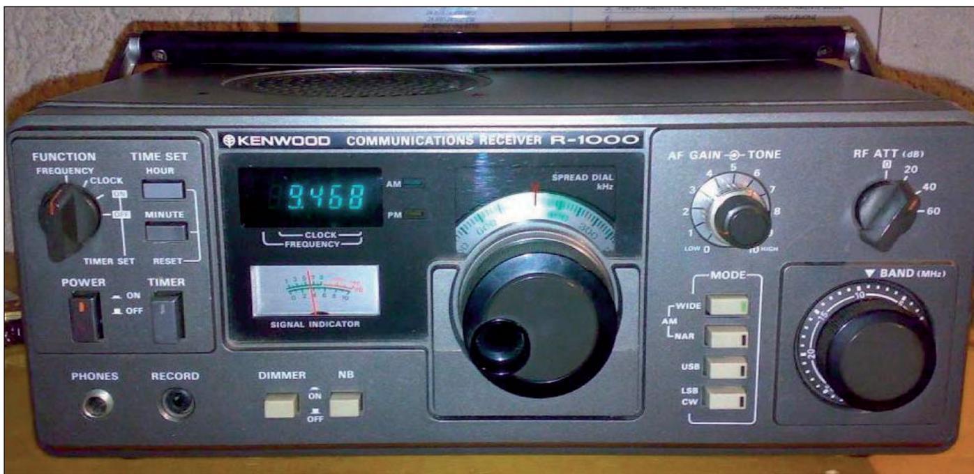
Figura 6: Kenwood R1000, il fratello maggiore dell'R600. Più o meno contemporaneo, vale qualcosa in più, ne condivide il sistema di sintonia ed è probabilmente l'ultimo a non utilizzare il PLL.
