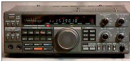
**Figura 10: Kenwood R5000, ricevitore di classe, interamente analogico, come molti esemplari della fine degli anni Ottanta era la versione senza trasmettitore di un ricetrasmittitore, nello specifico il Kenwood TS440.**
