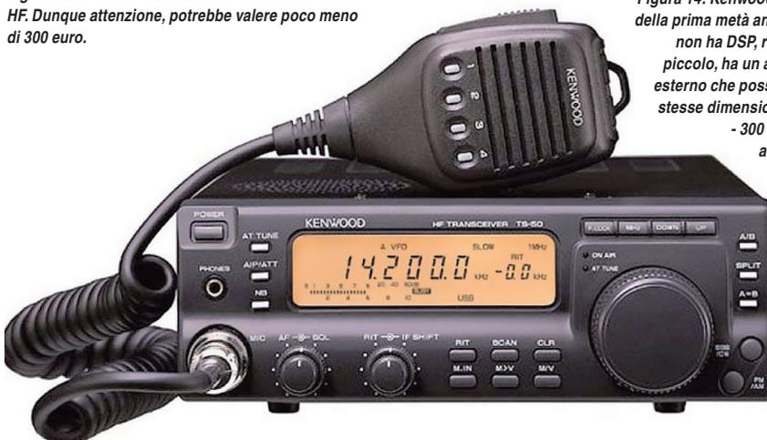
**Figura 14: Kenwood TS50, RTX della prima metà anni Novanta, non ha DSP, rtx piuttosto piccolo, ha un accordatore esterno che possiede le sue stesse dimensioni. Vale 250 - 300 euro, senza accordatore.**
