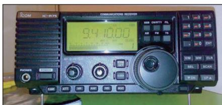
**Figura 11: Icom ICR75, molto più recente, è un ricevitore di classe, un'ottima scelta, forse eccessiva per chi è agli inizi. Come optional è disponibile il DSP.**
