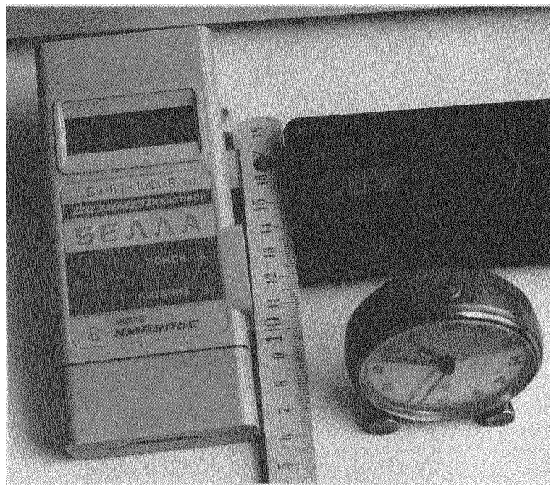
Foto 3 - Digitali, i modelli più modesti misurano solo emissioni gamma, il bEnnA a sinistra e il piccolo MacMep 1 che è più vicino all'orologio e la cifra indicata dal display è esattamente doppia!
