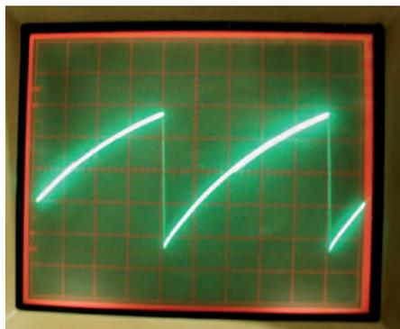
Figura 2: la forma d’onda presente sul pin 6 del 555.
