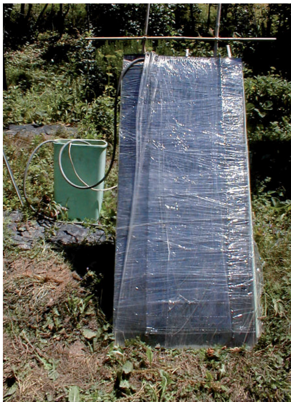
Figura 1 Il pannello in prova, con il contenitore da 40 litri
