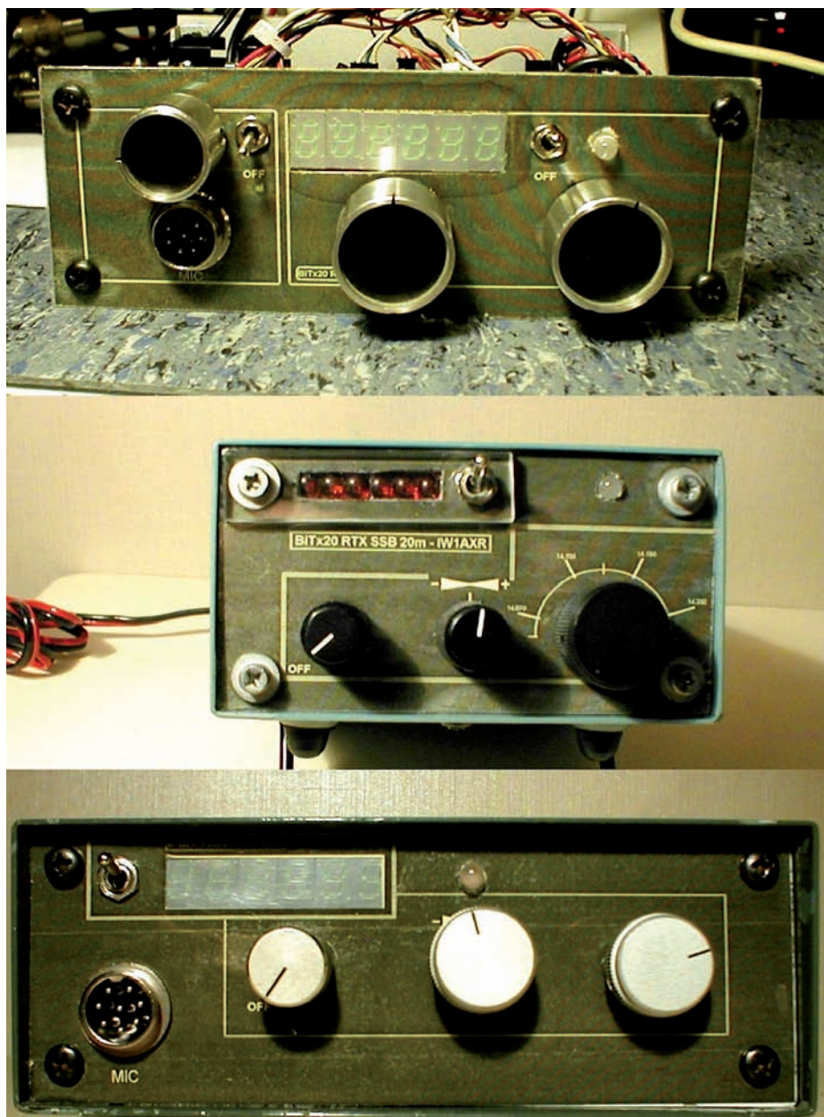
Figura 1 : i pannelli di tre ricetrasmittitori realizzati con questo metodo.
