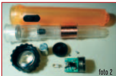
foto 1: la torcia originale foto 2: l'oscillatore montato e il diodo delle batterie
