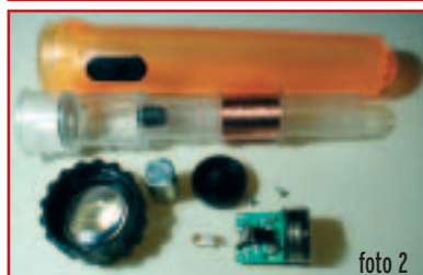
foto 1: la torcia originale foto 2: l'oscillatore montato e il diodo delle batterie
