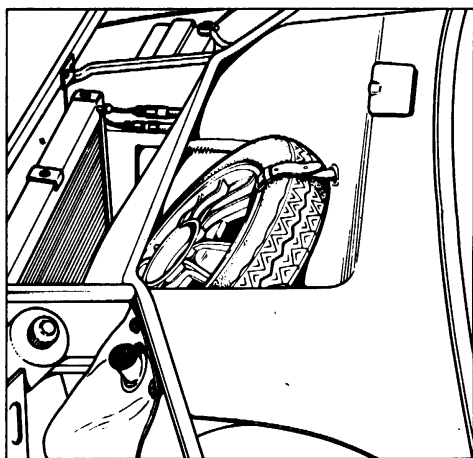
41) Posizione della ruota di scorta nel cofano anteriore.
