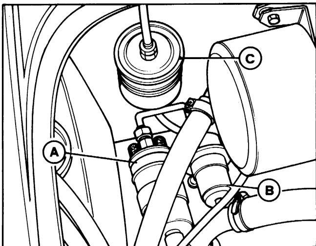
La pompa (A) aspira il carburante dai serbatoi e lo invia attraverso un accumulatore (B) e un filtro C al dosatore carburante.
