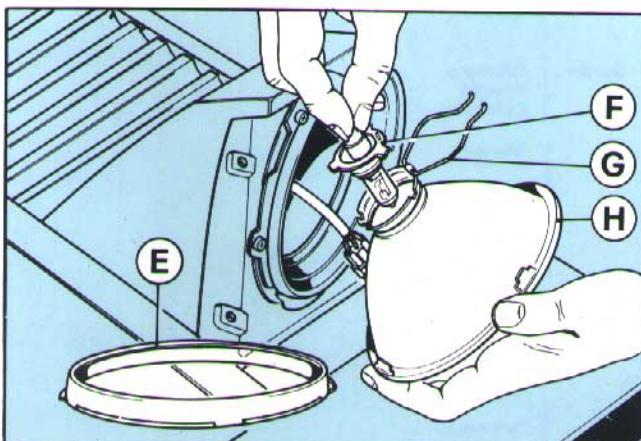
**80) Sostituzione lampada proiettore**
