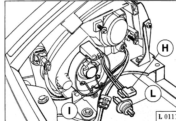
**Avant de remplacer une lampe des projecteurs, contrôler si le fusible correspondant est intact.**
