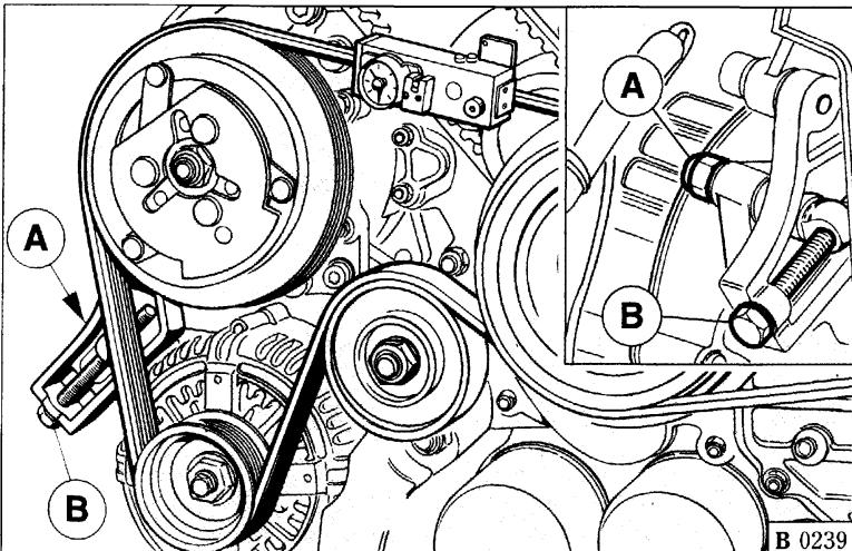
Fig. 9 - Tensionamento cinghia compressore A.C. e alternatore.
