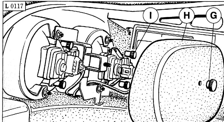
Fig. 12 - Sostituzione lampada
