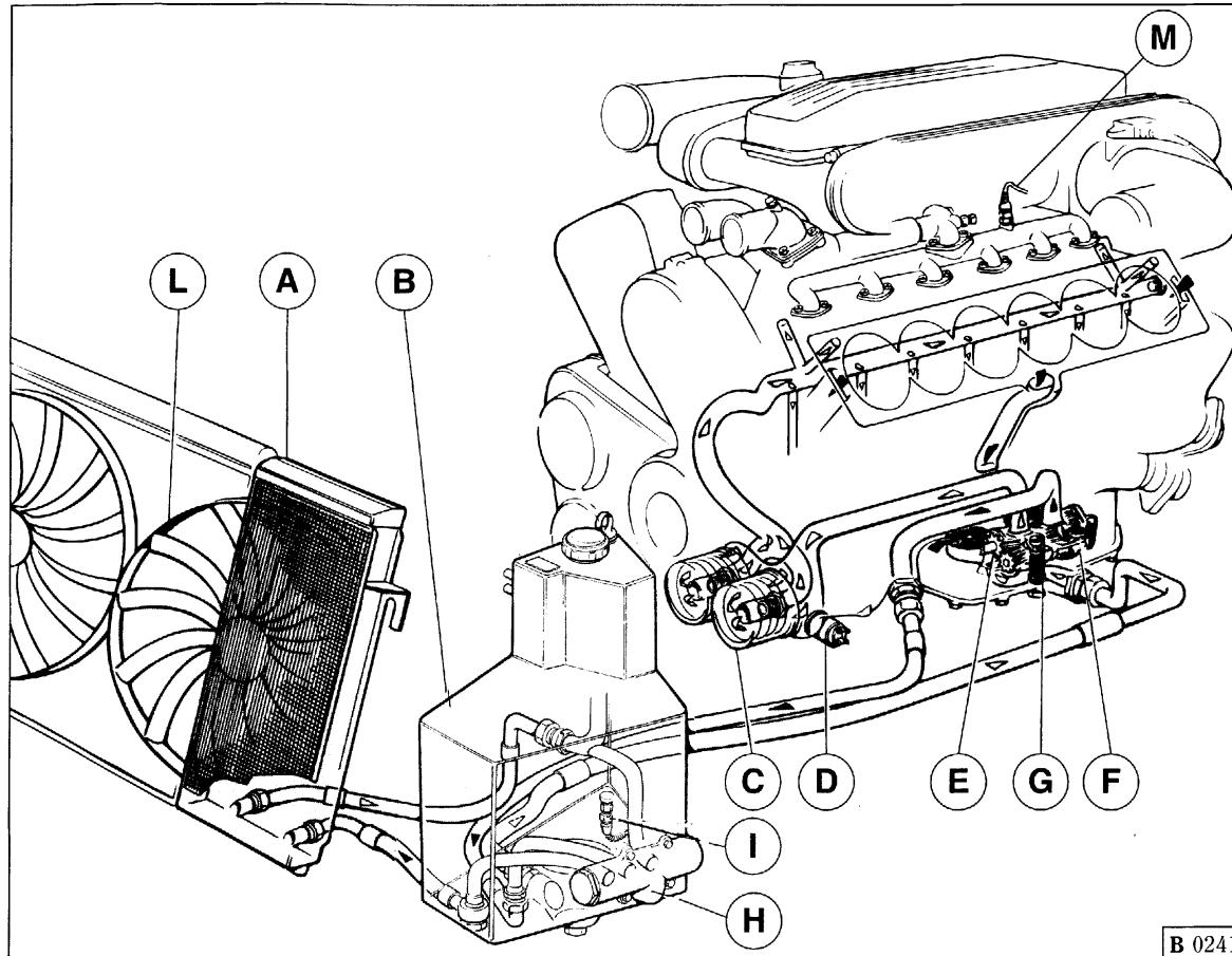
**Fig. 5 - Impianto lubrificazione**
