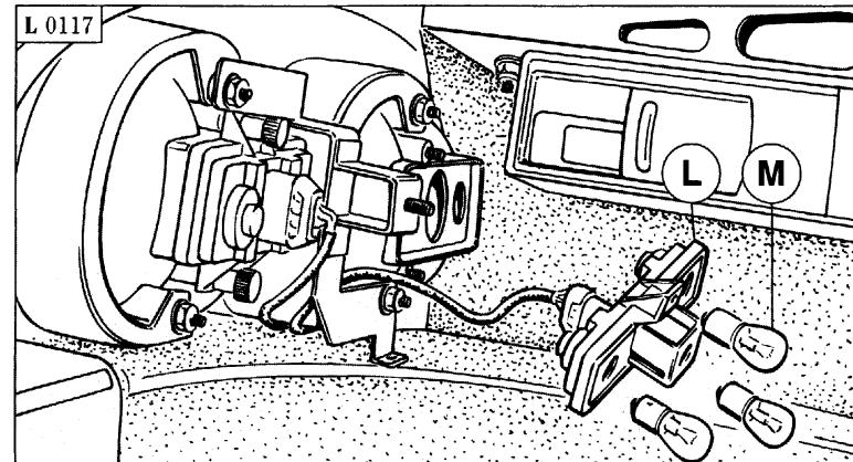
Fig. 12 - Remplacement de la lampe des feux arrière
