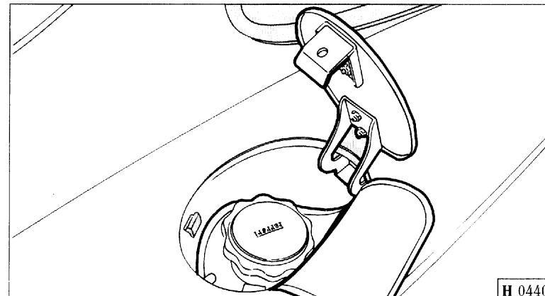
Fig. 30 - Fuel filler cap
