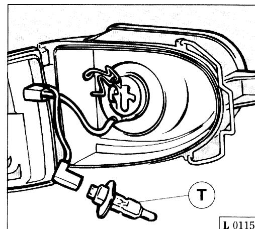
Abb. 10 - Ersatz der Nebelscheinwerferlampe.
