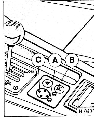
Lorsque l'on appuie sur le bouton **C** dans le sens vertical ou horizontal, on règle électriquement l'orientation des rétroviseurs.
