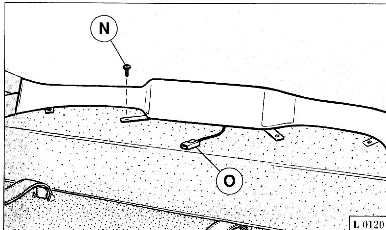
Fig. 14 - Sostituzione lampada luce stop supplementare.
