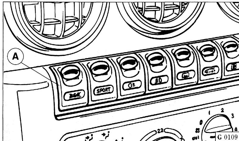
Fig. 19 - Interruttore per sistema ASR
