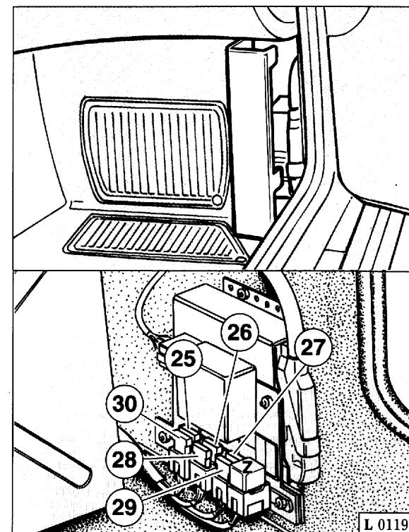
Abb. 15 - Steuergerät unter der Fußplatte auf der Beifahrerseite.
