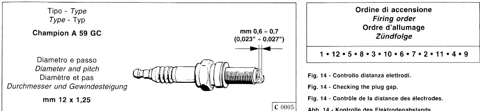
Fig. 14 - Controllo distanza elettrodi.
