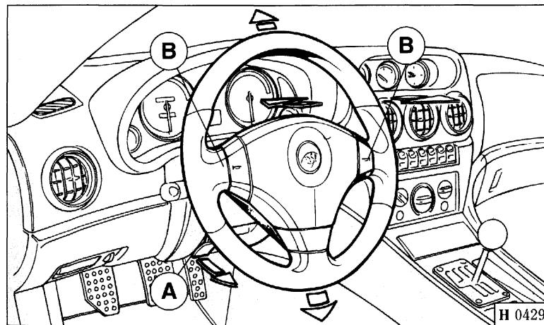
**Fig. 18 - Regolazione volante**
