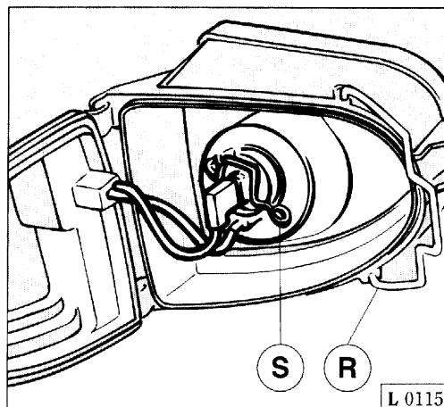
Fig. 10 - Remplacement de la lampe du feu antibrouillard.
