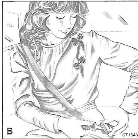
Per slacciare le cinture premere il pulsante 4 sul blocco ancorato al tunnel. Accompagnare le cinture mentre si reinseriscono nell'avvolgitore, evitando che possano attorcigliarsi. Per consentire il reinserimento completo della cintura nell'avvolgitore, fare scorrere sulla stessa la fibbia del gancio.
