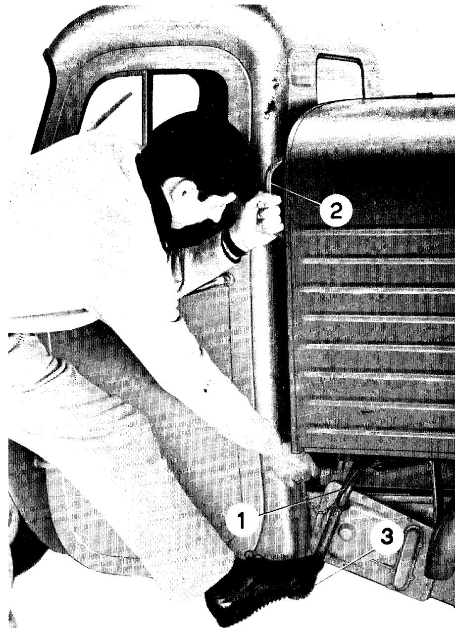
Fig. 14 - Elementi principali dei dispositivi di ribaltamento delle « carrozzerie ribaltabili »
