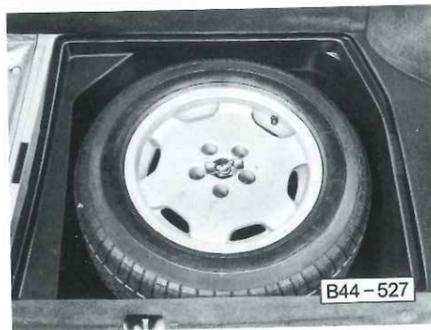
La vettura è dotata di ruota di scorta normale. In veicoli destinati ad alcuni Paesi, al posto della ruota di scorta con pneumatico normale si trova una ruota di soccorso di ridotto ingombro. La ruota di soccorso si trova in una nicchia sotto il rivestimento del fondo del bagagliaio. Essa è fissata mediante una vite ad alette godronata con staffa.
