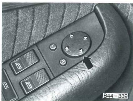
Il comando per gli specchi esterni a **regolazione elettrica** avviene con la piastra di registro (freccia).
