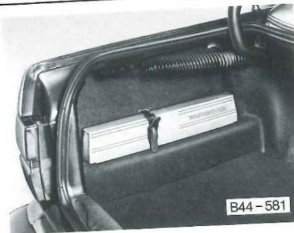
Il **triangolo catarifrangente \*** fornito dalla Fabbrica si trova nel vano bagagli. Esso è fissato con un nastro elastico.
