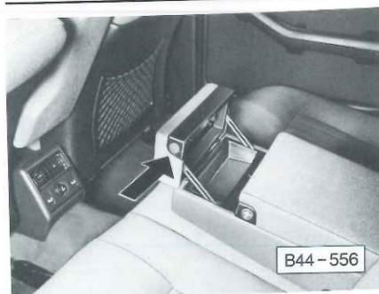
Nel bracciolo centrale posteriore si trova un vano posaogetti. Per aprirlo, premere il bottone di sbloccaggio laterale (freccia).
