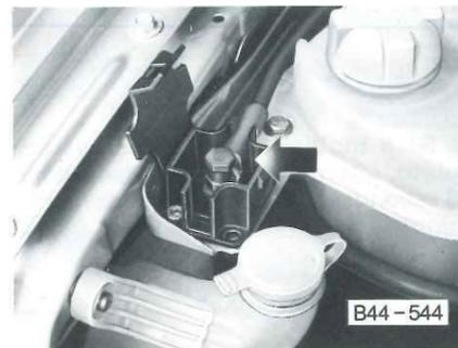
Nel vano motore si trova **una presa per l'avviamento d'emergenza**, che agevola in modo semplice e sicuro l'avviamento di emergenza. Questa presa è collegata al polo (+) della batteria. Grazie a questo dispositivo, non è normalmente necessario accedere alla batteria per l'avviamento d'emergenza.
