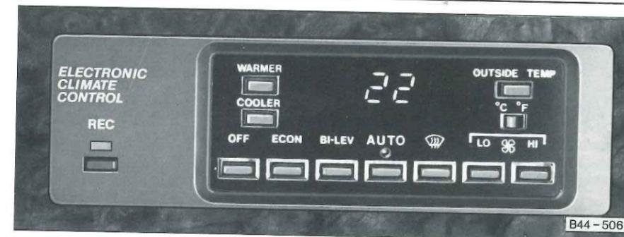
Il climatizzatore mantiene automaticamente la temperatura scelta per l'interno della vettura.
