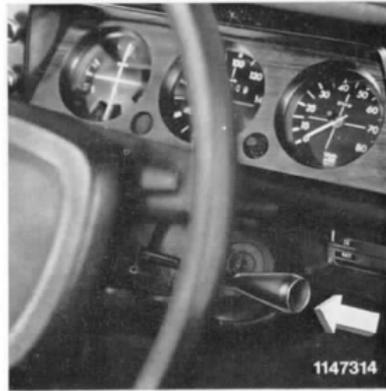
Premendo verso il volante la leva di comando degli indicatori di direzione si mette in funzione il **lavacrystallo automatico**. Nel medesimo tempo entrano in funzione una pompa elettrica e il tergicristallo. A operazione terminata, lasciando la leva, un relais provvederà a fermare il tergicristallo dopo alcune battute. **Figura 12**
