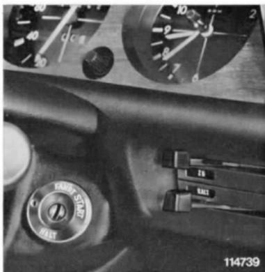
Per bloccare lo sterzo, ruotare la chiave nella posizione «Halt» ed indi estrarla girando, se necessario, leggermente lo sterzo, in modo da far inserire il dispositivo di bloccaggio. La chiavetta d'accensione può essere estratta solo in questa posizione.
