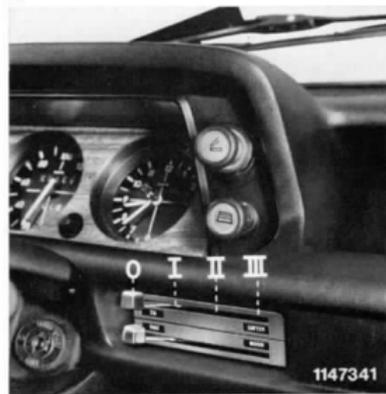
**Lunotto posteriore termico** (equipaggiamento speciale): **tirando l'interruttore per l'elettroventilatore** il lunotto posteriore, ad accensione inserita, viene riscaldato elettricamente. **Fig. 40**
