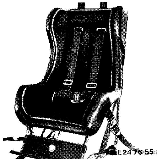
quest'ordine, in modo che il nastro della cintura si disponga bene sopra il bacino (non sul ventre!). Chiudere la cintura inserendo la linguetta di bloccaggio nella serratura a pulsante: deve udirsi distintamente lo scatto d'arresto.
