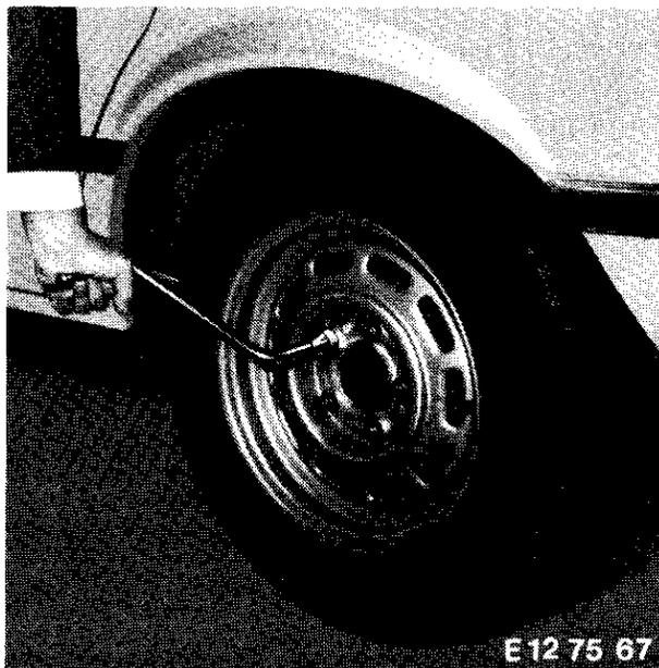
**Attenzione!** BMW 525, 528 i: mettere il cuneo d'appoggio dietro la ruota posteriore sul lato opposto di quella da cambiare, in modo che la vettura non possa muoversi all'indietro (ciò per via del modo in cui è costruito il freno a mano).
