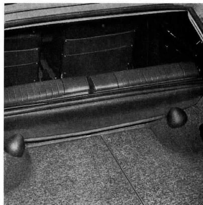
Il cassetto portaoggetti nel bagagliaio si può togliere ruotando con una moneta le due vite di fissaggio di 90°. **Fig. 16**
