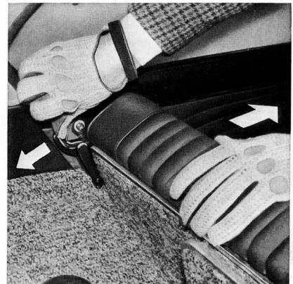
Gli schienali si arrestano in posizione orizzontale per mezzo delle levette di sicurezza. **Fig. 13**
