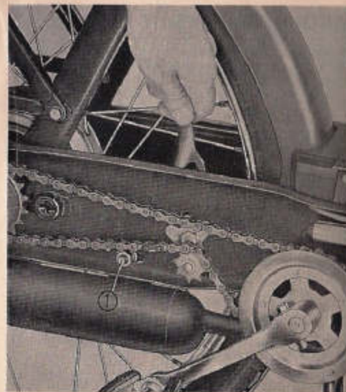
Fig. 11 - Regolazione tensione catena.
