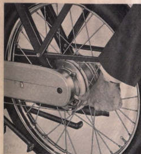
Fig. 8 - Azionamento levetta collegamento ruota posteriore al motore.
