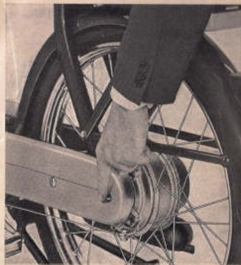
Fig. 7 - Azionamento pomello disinnesto ruota posteriore dal motore.
