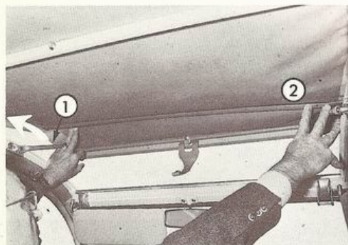
Fig. 25 - Apertura anteriore della cappotta 1 - Telaio anteriore 2 - Traversa
