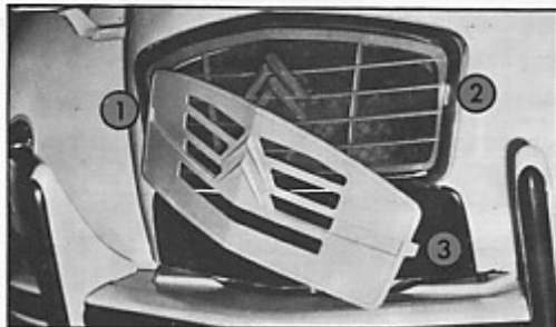
Fig. 20 - Applicazione della mascherina 1 - 3 - Linguette di fissaggio 2 - Alloggiamenti di fissaggio
