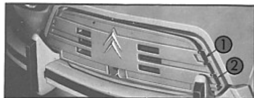
Fig. 23 - Montaggio della mascherina della calandra 1 - Gancio superiore di fissaggio 2 - Gancio inferiore di fissaggio
