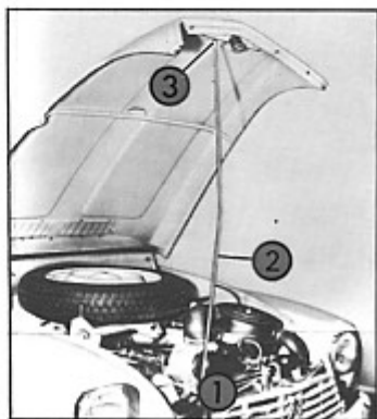
Fig. 6 - Coperchio vano motore 1 - Levetta di sicurezza 2 - Asta di sostegno 3 - Supporto di fissaggio
