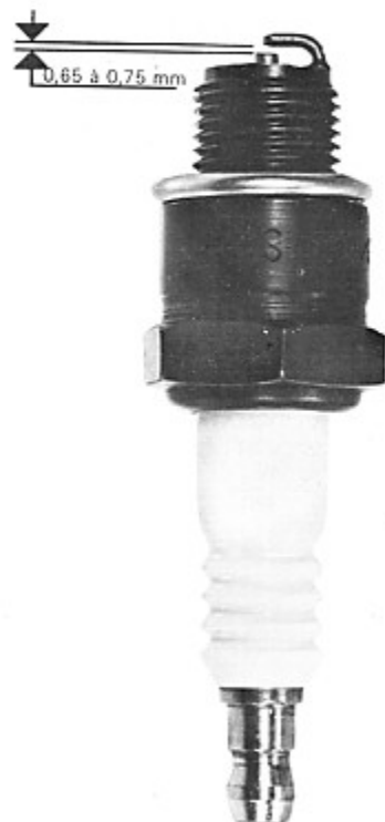
Fig. 35 -Apertura degli elettrodi
