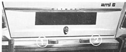
Fig. 34 -Illuminazione targa 1-2-Alloggiamenti lampade
