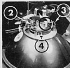
Fig. 41 -Abbaglianti -Anabbaglianti (dispositivi comuni) 1-Connettore 2-3-Molle di ritegno 4-Collarino della lampada
