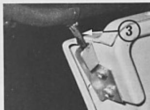
Fig. 34 - Smontaggio dei pannelli sup. delle portiere
