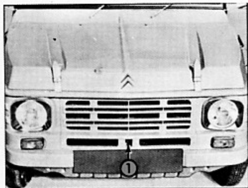
Fig. 62 - Avviamento con la manovella 1 - Foro per la manovella
